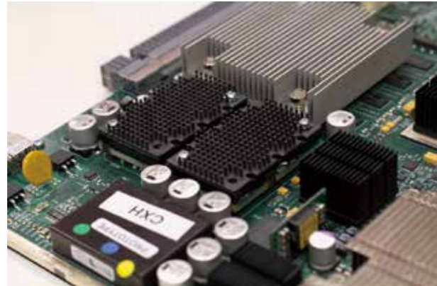
图4: 今天，两个四分之一砖并联可为IP交换机和路由器提供900W
