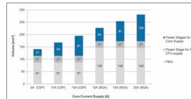
图2: TFM252010线圈在不同配置下的电路板面积需求
