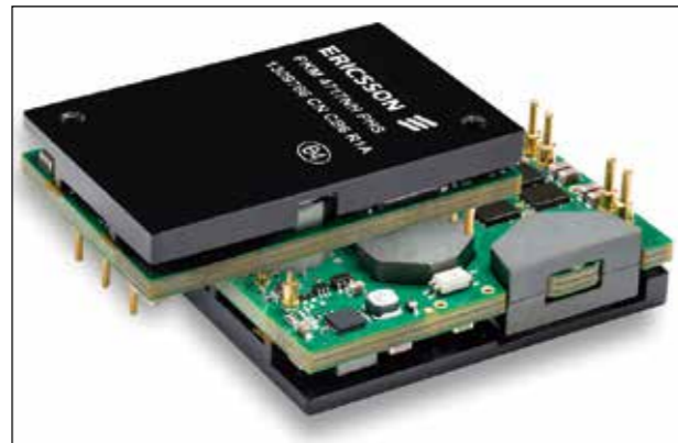
图5: 数据通信输入范围高功率密度864W四分之一砖模块采用双电源引脚和冷壁冷却来优化设计
