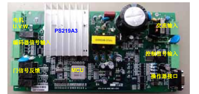
图10: 控制板外观 PCB设计不良可能导致的故障
