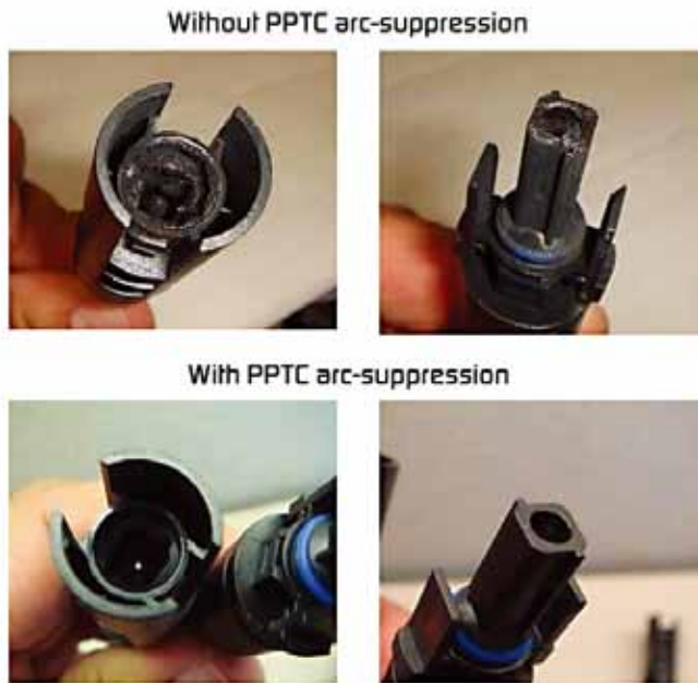
图5: 带或不带消弧器件的HVdc连接器上的等离子体电弧测试
