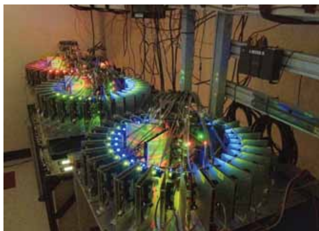
图 3：用 Element 的集成能源管理系统测试的电池组。
